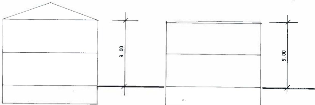
DACHNEIGUNG BIS MAX. 20°. KNIESTÖCKE U. DACHGAUBEN SIND NICHT ZUGELASSEN.
